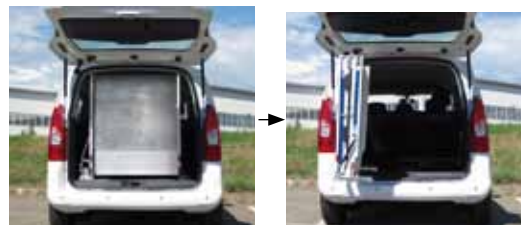
Optional: SUPERLIGHT con kit di rotazione esterna
