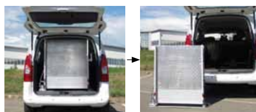
Standard: SUPERLIGHT si sgancia e si appoggia a terra
